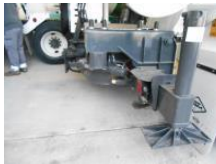
2 pivotes de engranes tipo grua (seguridad 100%) y estabilizadores reforzados derechos
